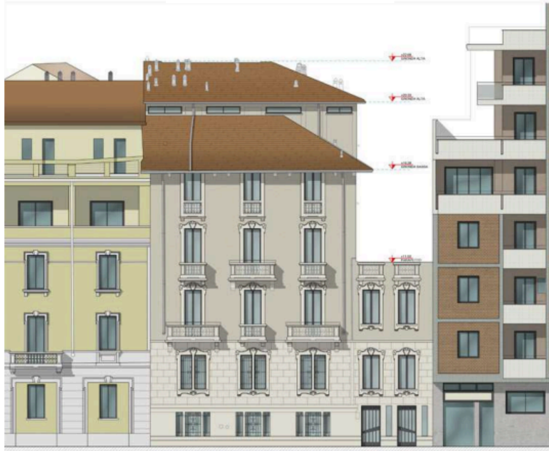
STATO DI FATTO - PROSPETTO CC' LATO INTERNO
